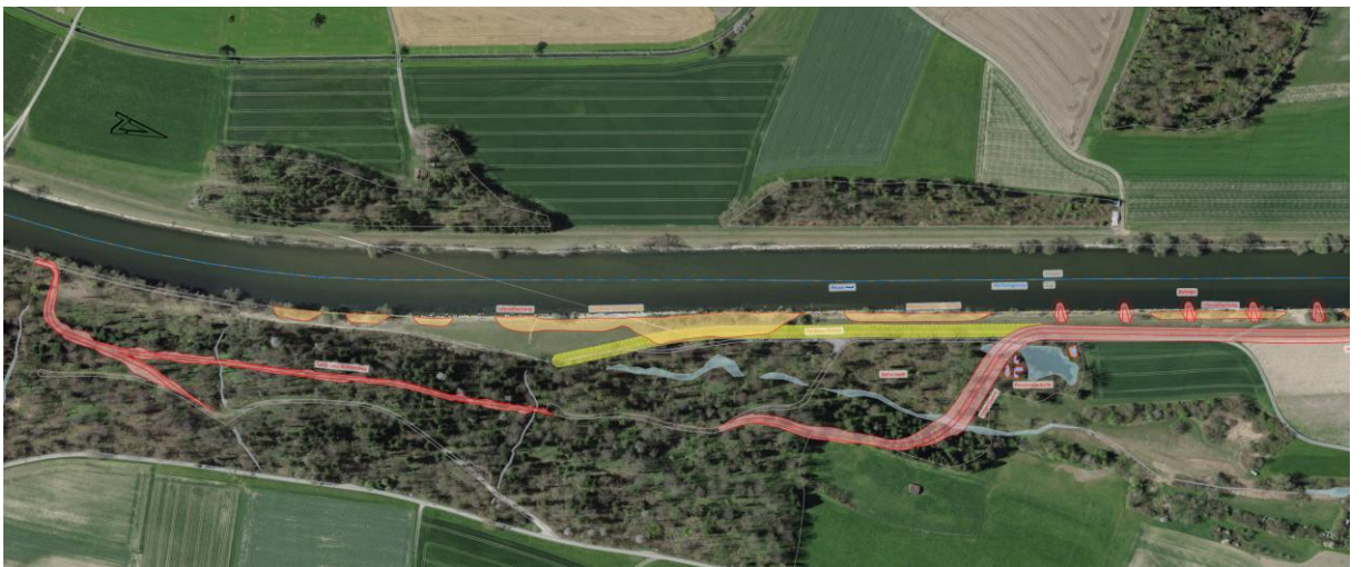
Abb. 11: Versetzen Damm mit Auengebiet Reusshalde (rot = neuer Damm, gelb = Rückbau bestehender Damm)
