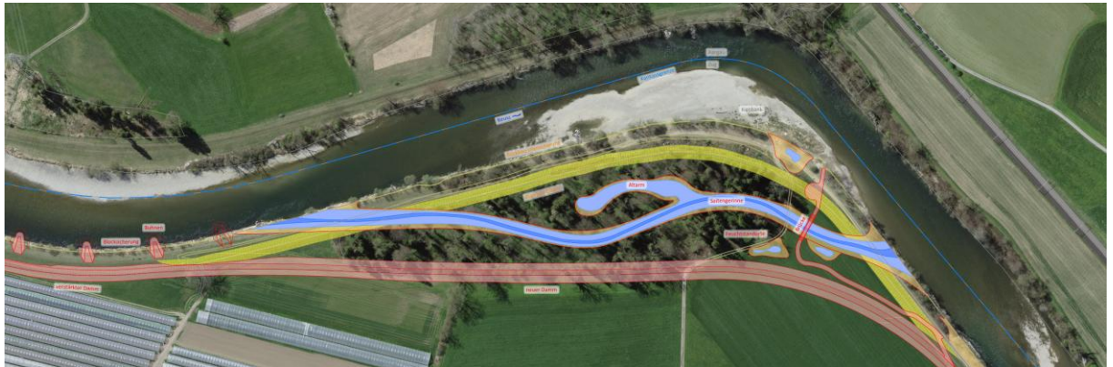
Abb. 16: Aufweitung Beugerank mit Seitengerinne, Altarm und Erholungsschwerpunkt (rot = neuer Damm, gelb = Rückbau bestehender Damm)
