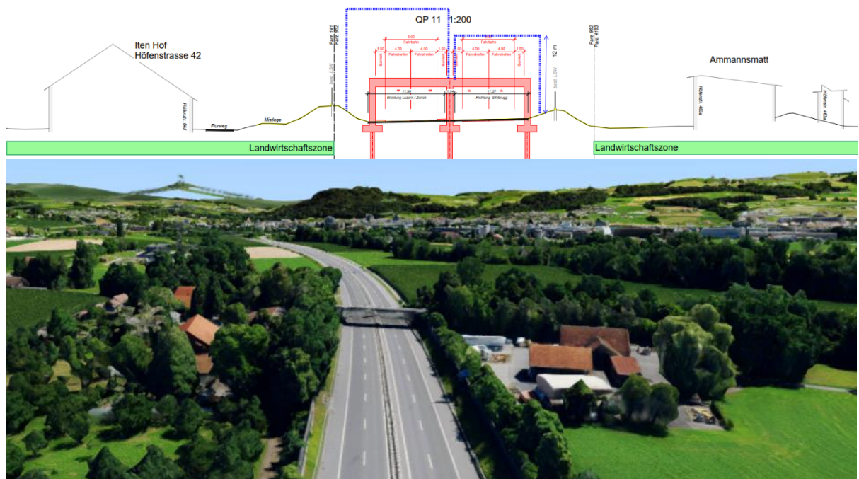
Abbildung 23: Querschnittsprofil 11 Bereich «Iten Hof» (QP 11 in Abb. 18) und Ansicht aus Zugmap.ch
