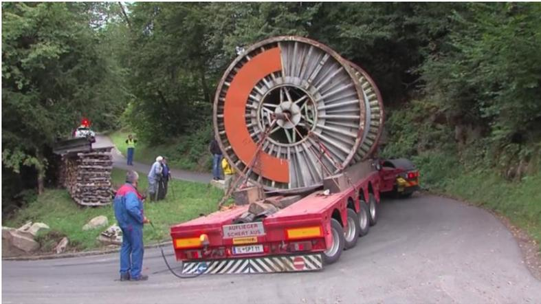
Abbildung 20: Kabeltransport für eine Verkabelung einer Hochspannungsleitung
