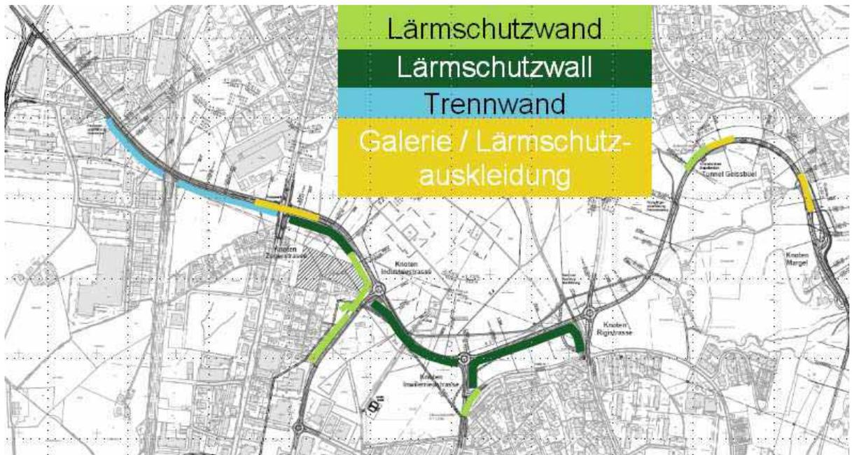
Entlang dem Neubauabschnitt und den Zubringern zu den Knoten sind an verschiedenen Streckenabschnitten Lärmschutzmassnahmen notwendig. Die einzelnen, vorgesehenen Massnahmen sind:
