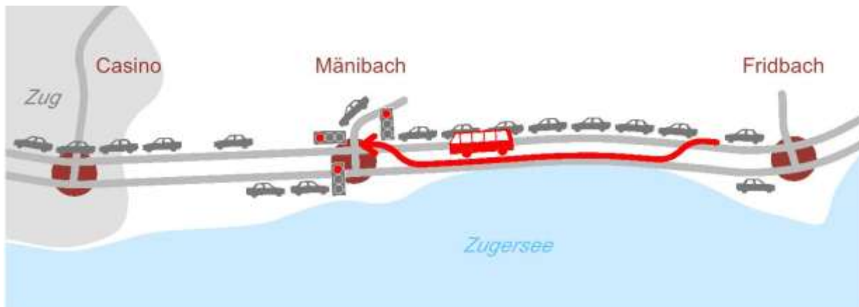
Schematische Darstellung der elektronischen Busspur
