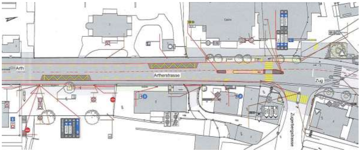
Haltestelle und Übergang Radfahrende sowie Fussgängerinnen und Fussgänger beim Casino
