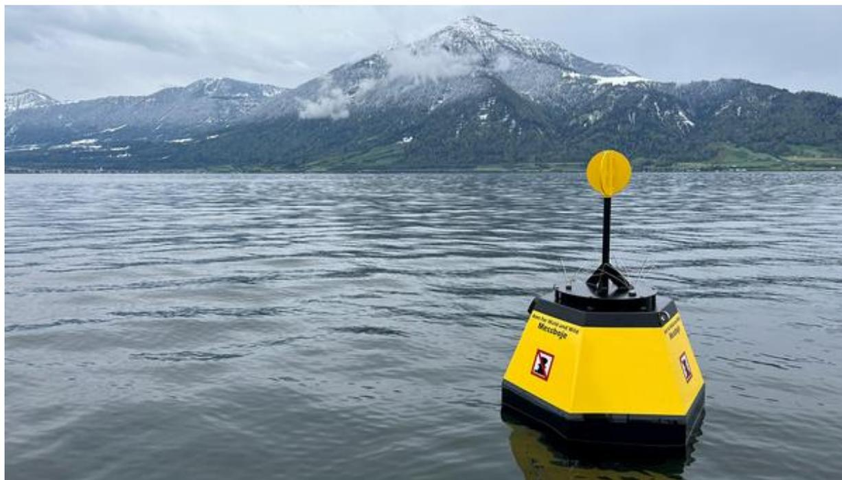
Abbildung 13: An dieser Boje ist das Aquascope im Zugersee vor der Fischbrutanstalt in Walchwil verankert (Quelle: Eawag)
