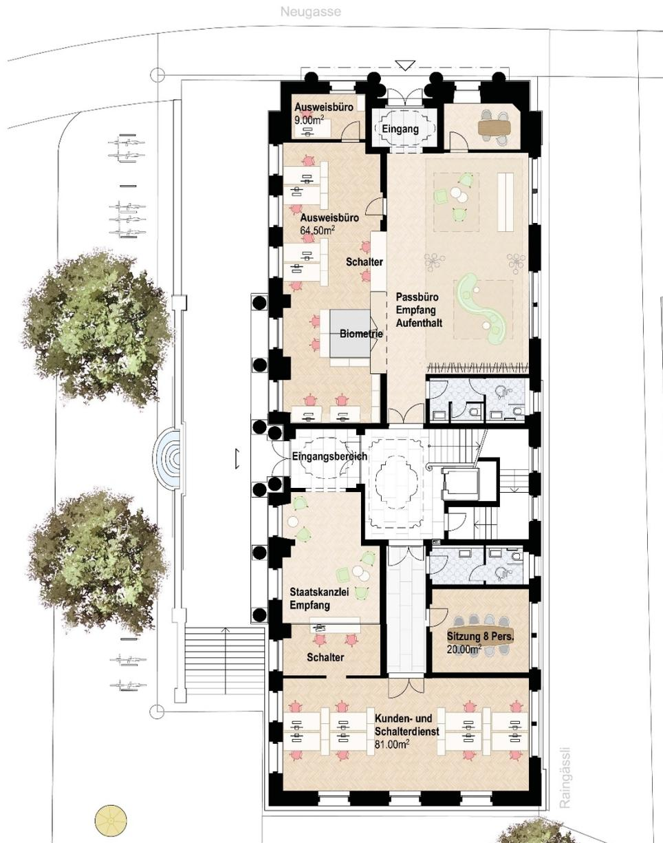
Neugasse 2: Grundriss Erdgeschoss
