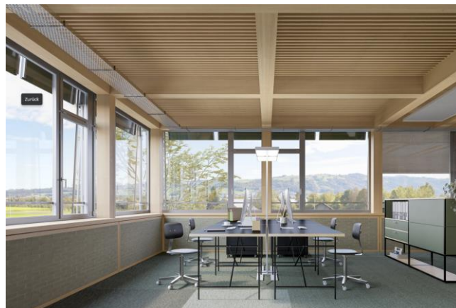
Abbildung 11: Einsatz von Lehmstein im Brüstungsbereich
